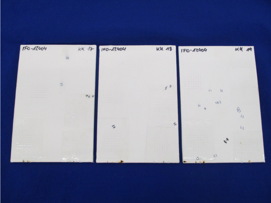
Abbildung 5 – Proben nach 240 Stunden KK-Prüfung
